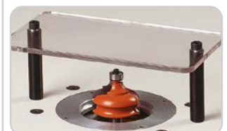
C999.501.06 Die Schutzvorrichtung macht Freihandfräsen sicherer
