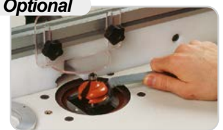
Gebogener Schlüssel C991.006.00 zum einfachen Werkzeugwechsel
